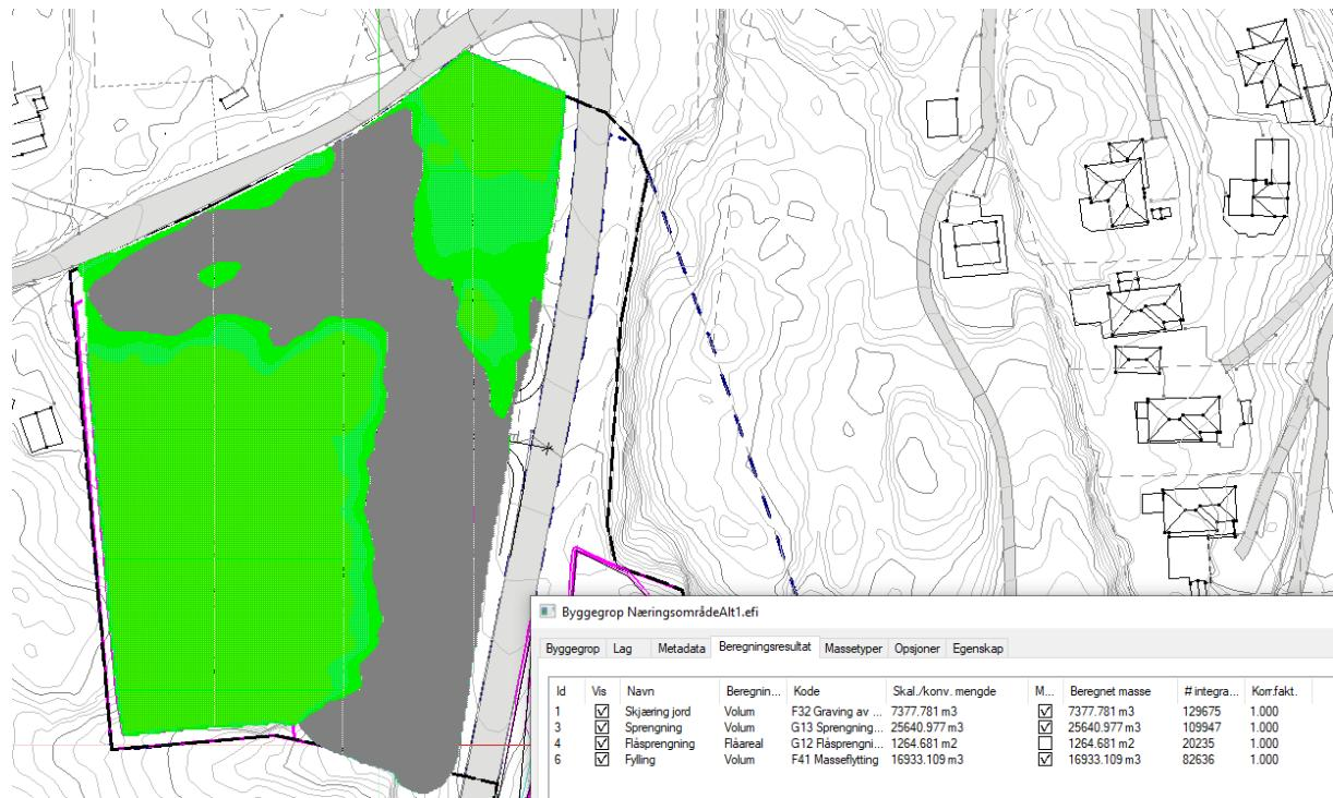
Massebereking byggegrop: 8716,9 m<sup>3</sup> med overskotsmassar. Grøn farge er skjering /grå farge er fylling.
